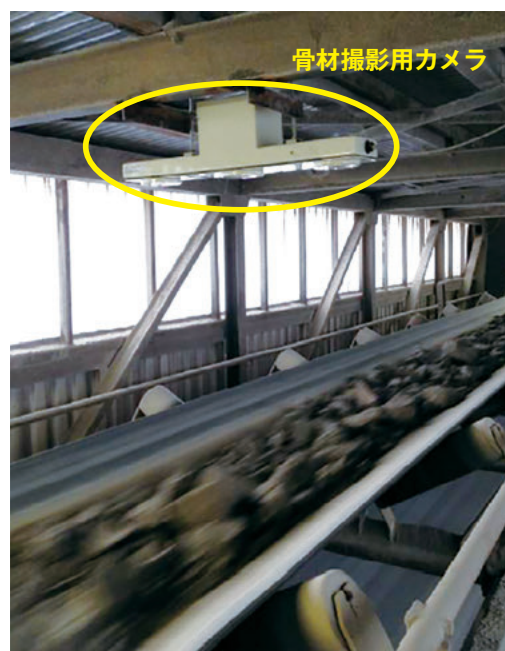
写真1 骨材スキャン用カメラ
