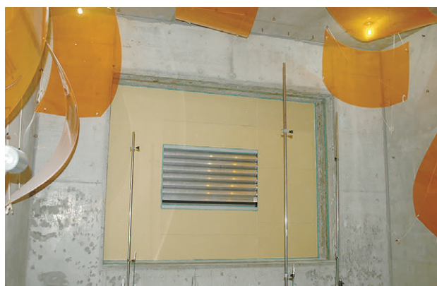
写真3 音響透過損失試験状況
