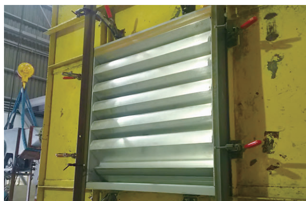
写真4 通気性能試験状況
