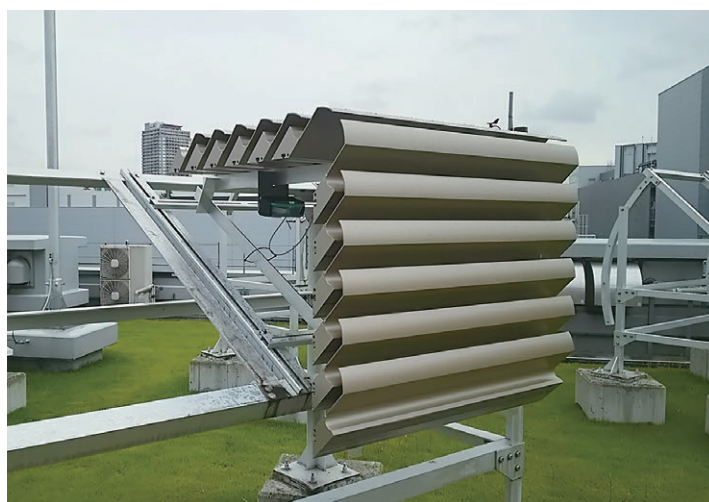
写真6 耐候試験 試験体設置状況
